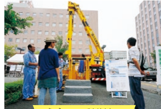
橋りょう点検車
