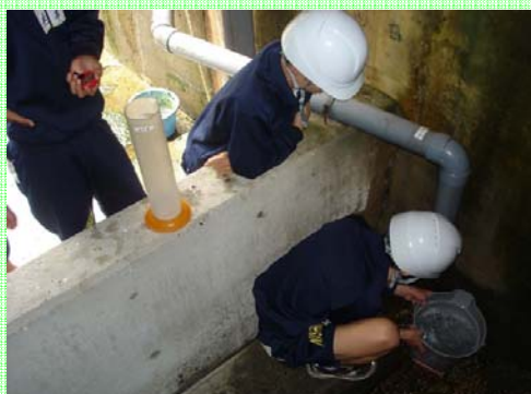
ダムの漏水量測定
