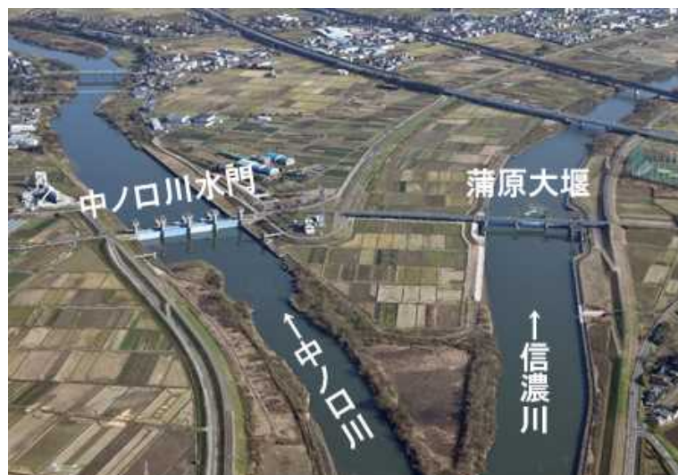
洪水や渇水に備えて、信濃川と中ノ口川で計画的に水の量を調節する蒲原大堰と中ノ口川水門（三条市・燕市）
