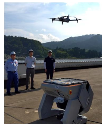
ドローンポートから 離着陸する様子
