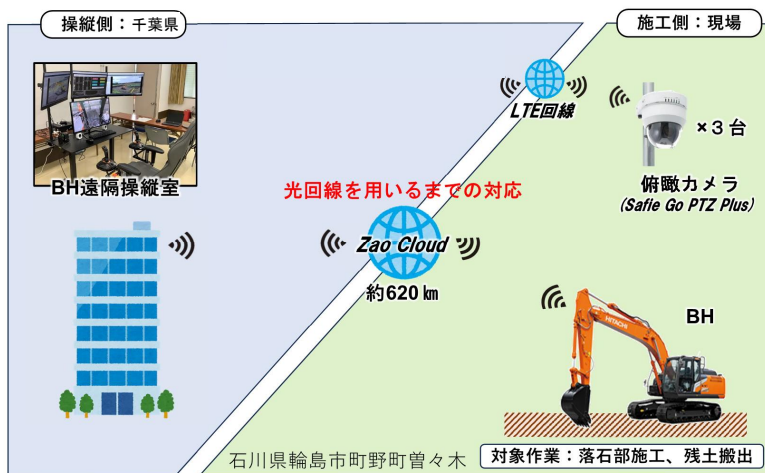
遠隔操縦概要図 ((株)大林組提供)
