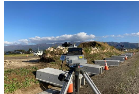
OPTIM Geo Scan Advanceでの点群測量
