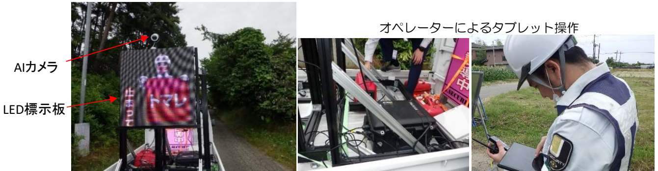
KB-eye for 交通誘導警備：実際の機材と操作オペレーター配置
