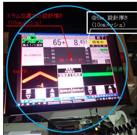
ICT施工 路面切削完了
