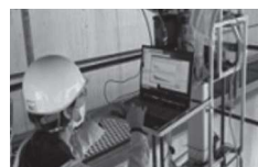
国土交通大臣賞 中性子によるコンクリート塩分濃度非破壊検査の技術開発 理化学研究所
