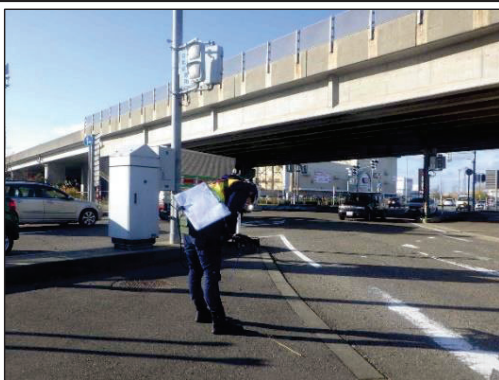
・高性能赤外線カメラによる剥落調査 (Jシステム)
