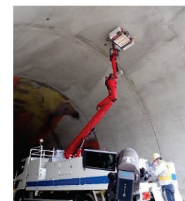
レーザー打音による変状の把握
