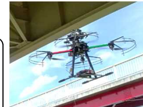
ドローンによる損傷把握
