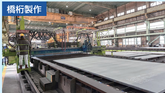
製作工場で設計図をもとに鋼板を加工します
