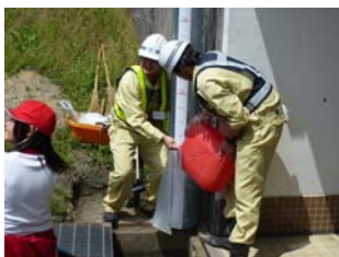
冠水を知らせる回転灯の実験 (10cmまで水を入れると 回転灯が点灯！)
