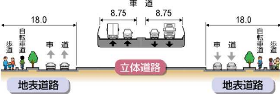
県道新潟港沼垂線区間の断面イメージ
