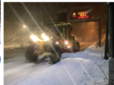
除雪グレーダ ふくとり 国道49号阿賀町福取地先
