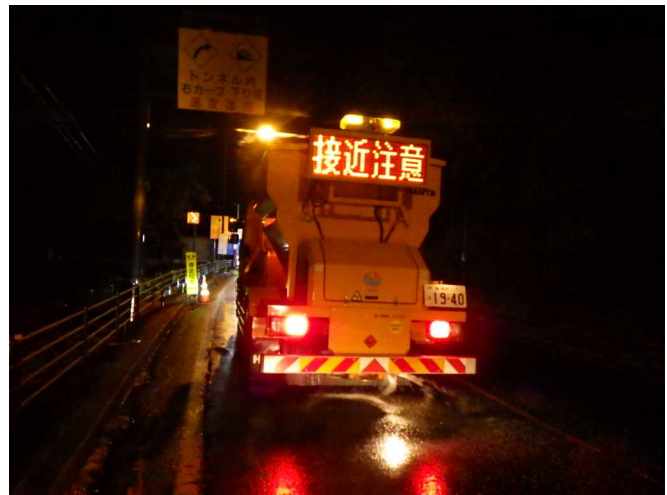
20日午後22時30分～23時20分の 国道113号関川村大内湊における 凍結防止剤散布状況
