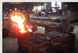
▲当初の形に復元するため、木型をおこし、型枠を造り、溶かした鉄を流し込んで固まるのを待ちます。
