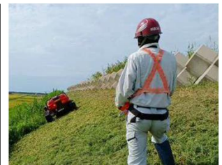
新技術による急斜面の機械除草
