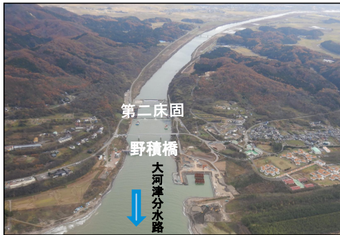
流下断面が不足し、抜本的な改修が必要な大河津分水路
