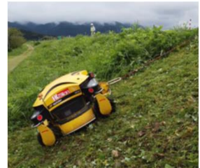
新技術による 急斜面の機械除草
