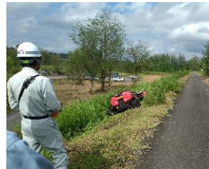
大型遠隔除草機械 による効率的な除草
