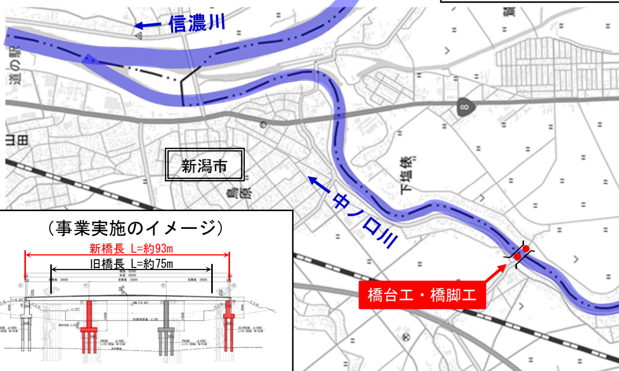
旧橋梁が流下を阻害 （越流による破堤の危険）
