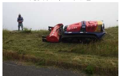
大型遠隔式除草機械による除草
