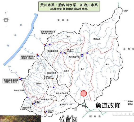
河床低下により魚道から魚が上れない箇所の改修を行い機能回復を図る
