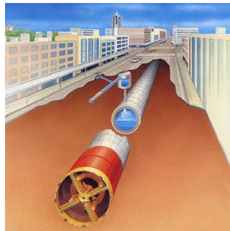
都市の浸水対策「新潟市木戸地区雨水貯留管整備」 (新潟県)
