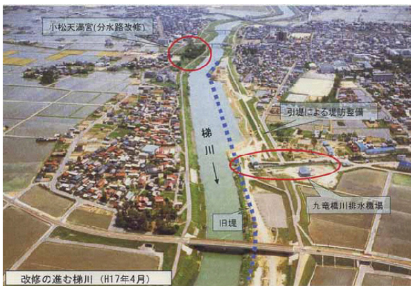
洪水を安全に流すため、梯川重点区間改修 事業を推進（石川県小松市）
