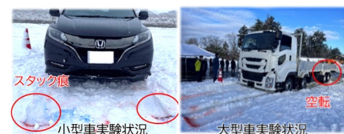
写真-2 小型車・大型車のスタック実験状況
