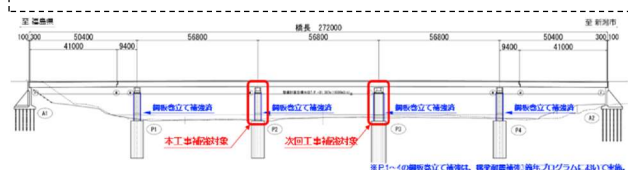
図-2 本工事による補強対象箇所
