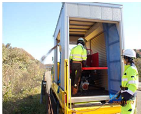
写真-5 木材破砕機による吹き付け
