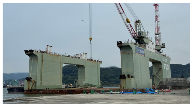
図-5 フローティングドッグ(FD)7500t級
