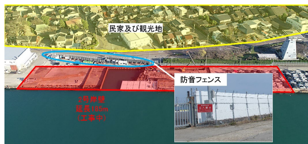
図-8 防音フェンス設置位置図
