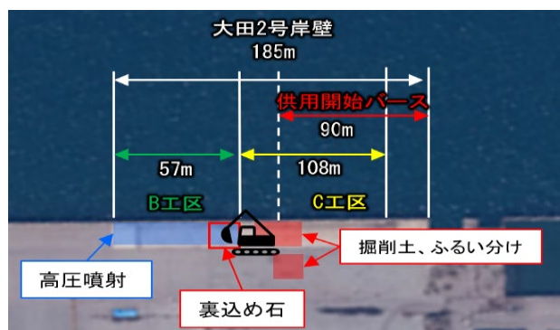
図-10 裏込め石撤去イメージ図
