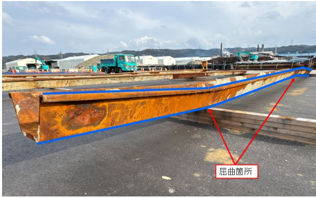
図-12 S字状に屈曲した既設鋼矢板
