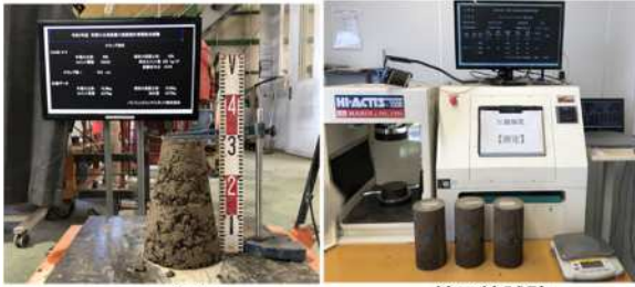
スランブ試験 一軸圧縮試験 写真-3 配合試験の状況
