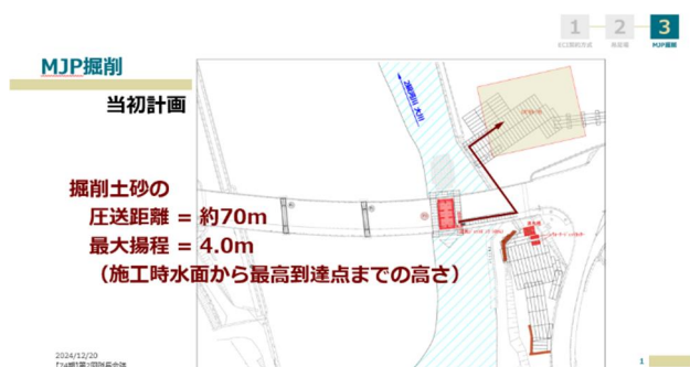
図-3 掘削土砂排出先(当初計画)
