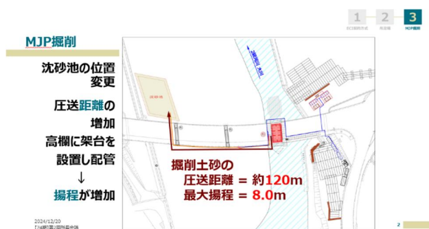
図-4 掘削土砂排出先(変更後)
