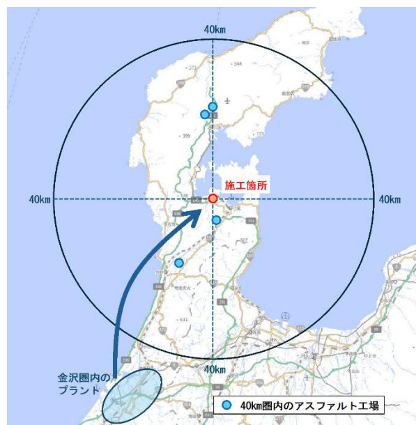
図-2 施工箇所から40km圏内のアスファルト工場
