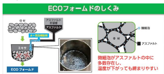
図-3 ECOフォームドのしくみ
