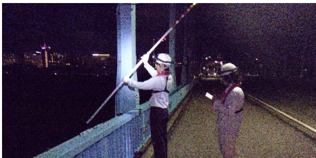
写真-1 深夜における高水流量観測の浮子投下状況
