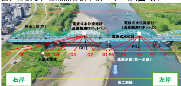
図-5 電波式水位流速計の設置位置と観測範囲
