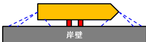
図-6 船体動揺量計測時の係留方法
