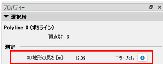
写真-10 3D モデルから法面を算出
