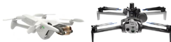
写真-6 今回の検証で使用したUAV 6) （左：ANAFI Ai 右：Skydio X10）
