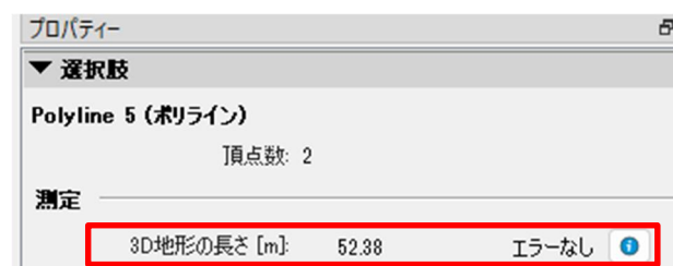
写真-9 3Dモデルから被災延長を算出
