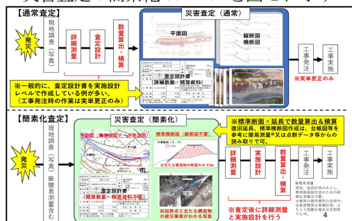
図-2 通常査定と簡素化査定の考え方
