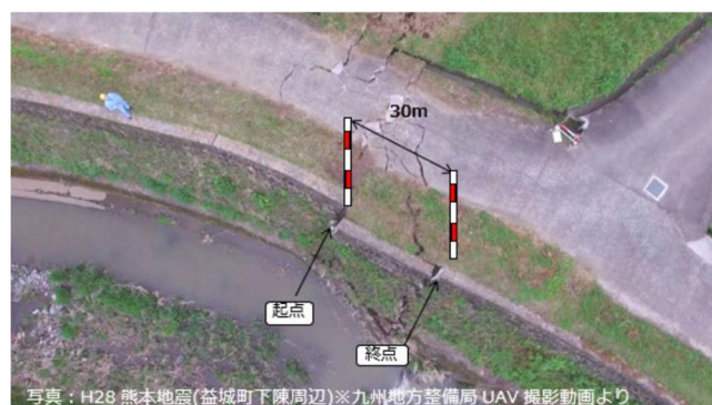
写真-5 ドローンによる空撮写真で査定設計書の平面図を作成した事例 1)
