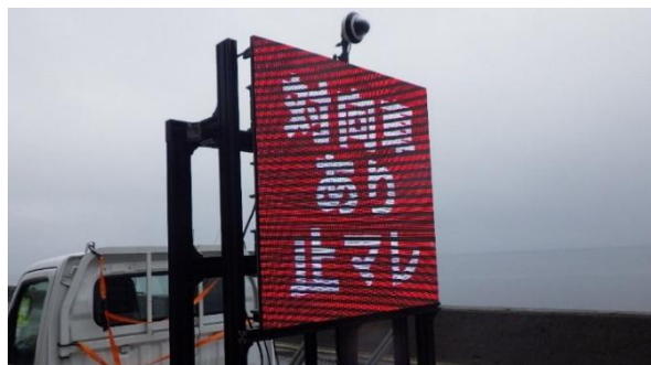
写真-2 起終点設置モニター,カメラ
