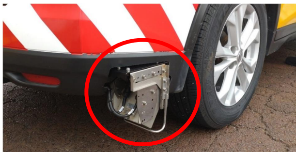
写真-1 パトロール車による車載式塩分濃度システム
