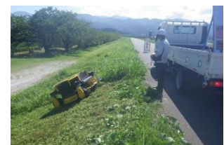
写真-4 スパイダー （石張護岸に適用可能な除草機械）
