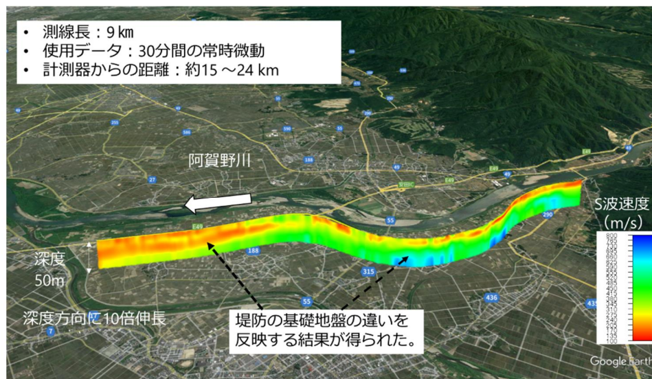
図-7 DAS計測によって推定したS波速度断面の鳥瞰図（断面の深度は10倍に伸長）
