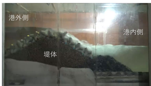
写真5 再現津波を堤体（傾斜堤）に作用させている様子の一例
