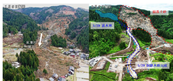
図-4 湛水池からの仮排水路設置（輪島市市ノ瀬町）
