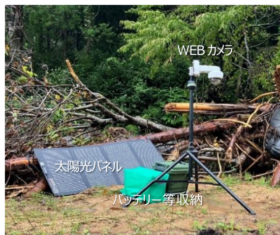
写真-6：モバイル伝送カメラ （寺地川上流）
