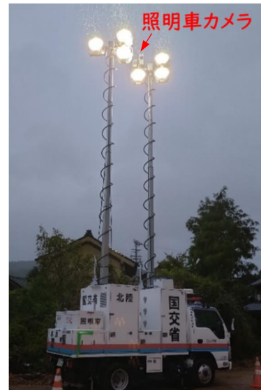
写真-11：照明車搭載のカメラ （寺地川中流）
