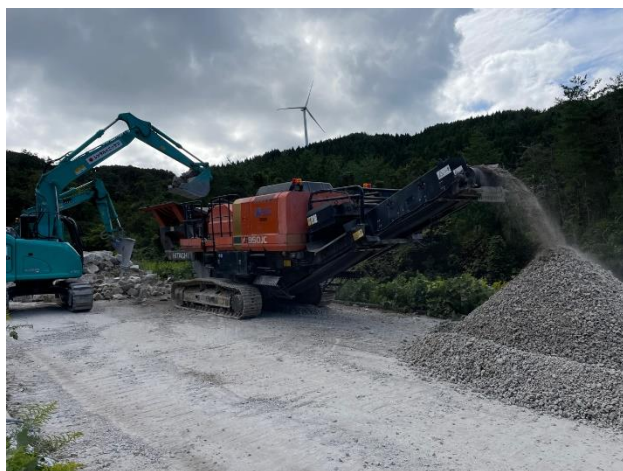
写真5 自走式破碎機の稼働状況
