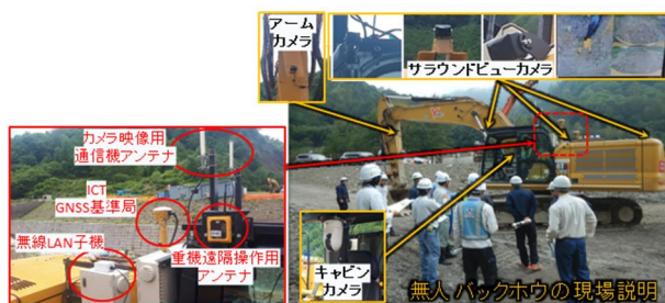
図-16 無人バックホウ機械、機器の現場説明
