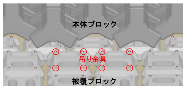
図-14 吊り金具の切断（現行構造）
