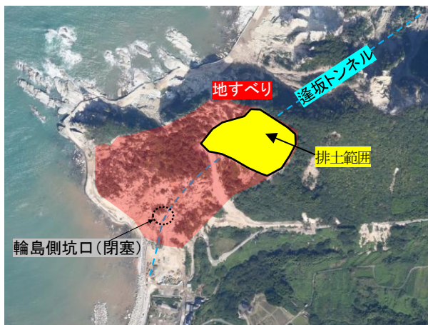
図-7 地すべりにより閉塞した逢坂トンネル輪島側坑口
