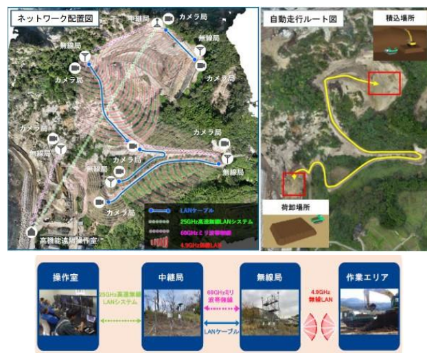
図-8 現場内のネットワーク構築状況と運搬車の走行ルート（熊谷組 広報資料より）
