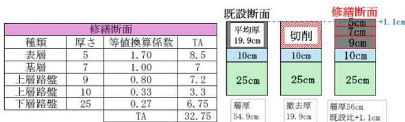
②表層と基層に新技术A（TA=1.7）を使用した切削オーバーレイ工
